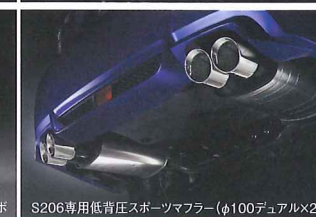
S206専用低背圧スポーツマフラー(φ100デュアル×2)
