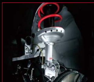
■ STI製チューニング・倒立式フロントストラット、 STI製チューニング・スプリング
