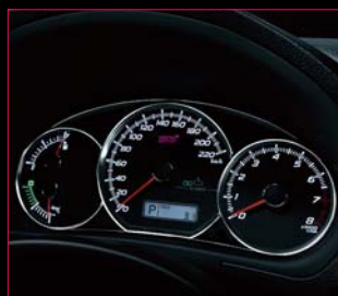
■ 専用エレクトロルミネセントメーター (STIロゴ入り、220km/h表示)
