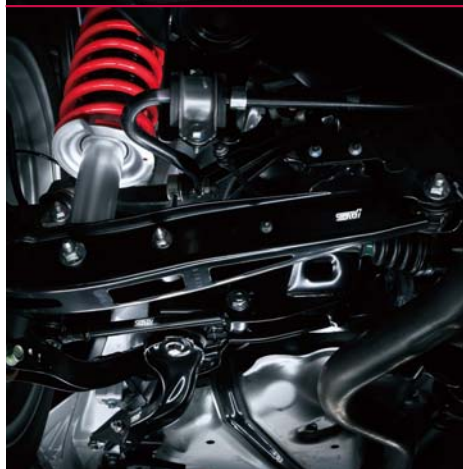
■ STI製チューニング・倒立式フロントストラット、 STI製チューニング・スプリング
