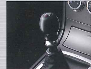
専用軽量ジュラコンシフトノブ アルミ製シフトブーツリング
