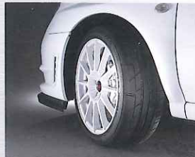
専用235/40R18タイヤ (ボテンザRE070) 専用鍛造アルミホイール 18インチX8.5J (ホワイト塗装)
