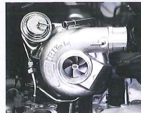
専用大型ツインスクロールターボ (ボールベアリング)
