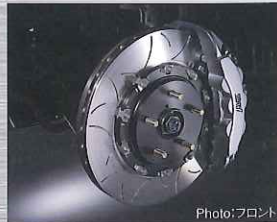
専用モノブロック対向6ポット フロントブレーキキャリパー 専用18インチ2ピースタイプブググループド フロントディスクローター
