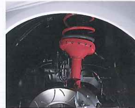
専用チューニング倒立式4輪ストラット 専用強化ローダウンスプリング
