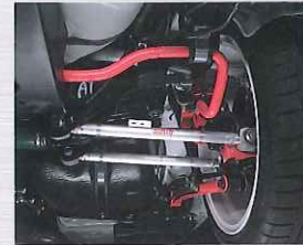
ピロボールブッシュ付アルミ製リヤラテラルリンク ピロボールブッシュ付リヤトレーリングリンク 専用φ22リヤスタビライザー
