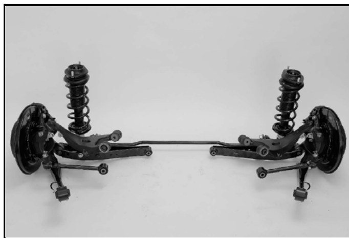
U) Train arrière complet déposé Complete dismantled rear axle 取り外したリアアクスル一式
