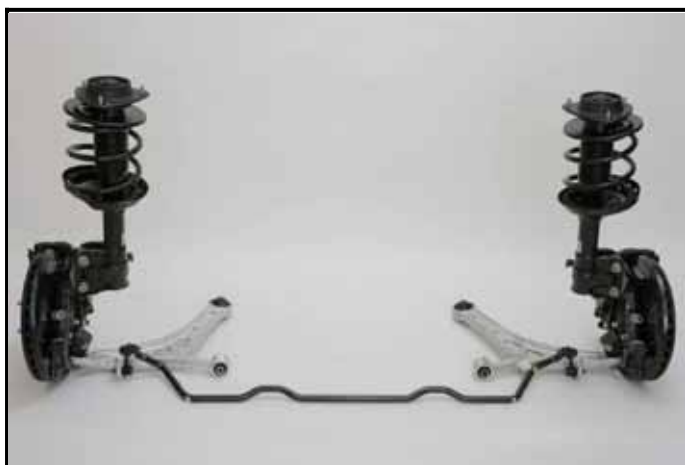
T) Train avant complet déposé Complete dismantled front axle 取り外したフロントアクスル一式
